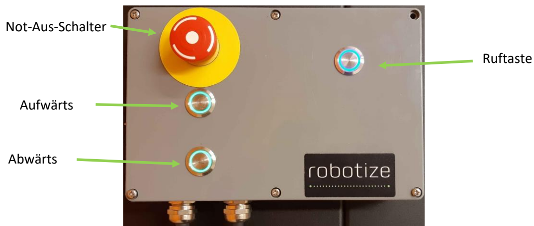
Abbildung 28 Bedienfeld der GoPal Elevation-Palettenstation
